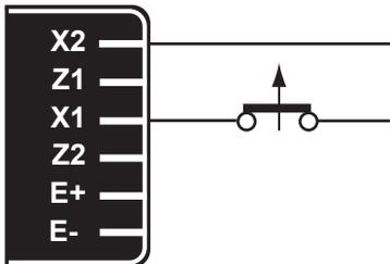
El corte de la excitación se consigue mediante el corte de la alimentación del regulador. (1 hilo - X1 o X2).
