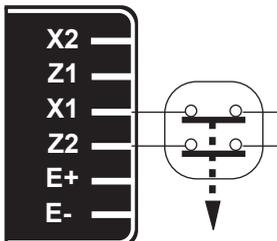
El corte de la excitación se produce mediante el corte de la alimentación del regulador (1 hilo en cada bobinado auxiliar); calibre de los contactos 16 A - 250 V alt.
